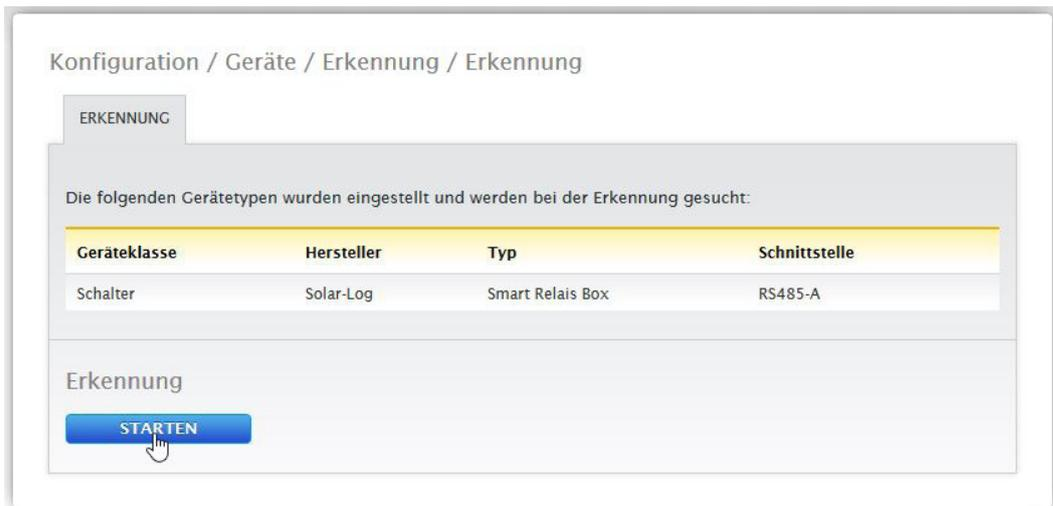
Nach der Erkennung muss die Konfiguration der Nennleistungen, die an den Kontakten angeschlossen ist, unter [Konfiguration | Geräte | Konfiguration | Konfiguration](#) vorgenommen werden.
